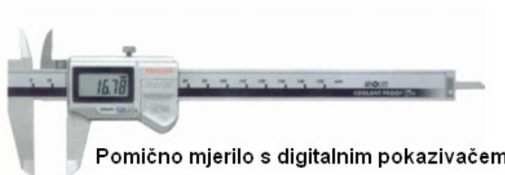
Pomično mjerilo s digitalnim pokazivačem
